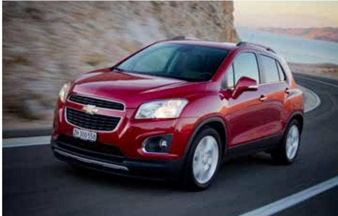
Benzinmotor oder Diesel. Im Test konnten wir uns mit dem benzinbetriebenen Motor anfreunden. 140 PS aus 1,4 Liter Hubraum widerlegen auch den Spruch, dass Hubraum durch nichts zu ersetzen ist. Wenn der Trax flott bewegt werden soll, darf man im Sechsganggetriebe kräftig röhren, aber im Alltagsbetrieb kommt er mit erstaunlich niedrigen Drehzahlen
